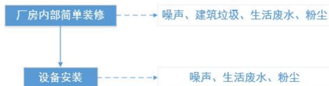
图 2.2 项目施工工艺流程
