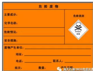
室内危险废物警告标志
