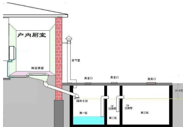
图 4-10 附建式三格式户厕示意图
