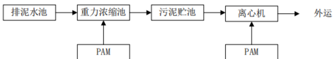
图3 现有工程污泥处理工艺流程图
